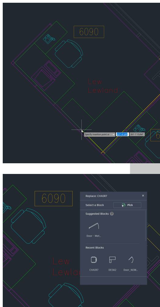
Fig.3 – Smart Blocks: posizionamento (alto) e Smart Blocks: sostituzione (in basso)
